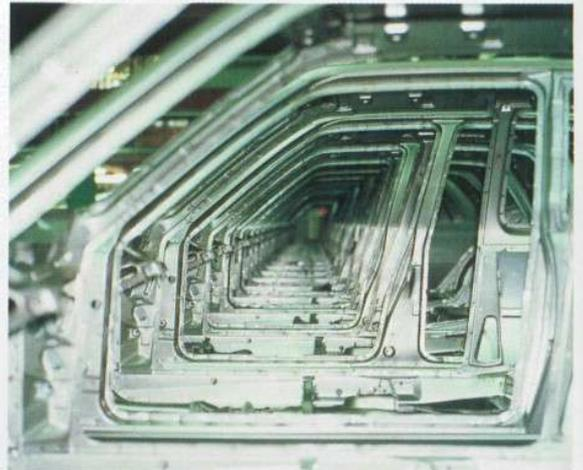
Harzen überzogen. So erhält das Fahrzeug maximalen Schutz gegen aggressive Korrosionseinflüsse. Ein Großteil der Karosserie wird ohnehin schon aus elektrolytisch verzinkten Blechen hergestellt. Diese aufwen-
